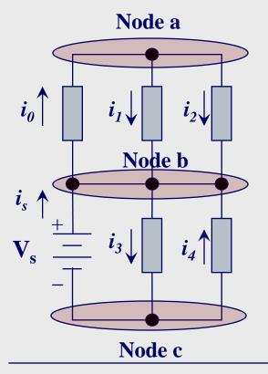
Find  $i_0$  at Node a:  $i_0 - i_1 - i_2 = 0$   $i_0 = i_1 + i_2$  = 2 - 3= -1 A
