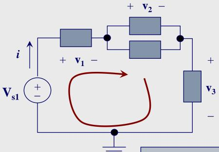
$$-v_{s1} + v_1 + v_2 + v_3 = 0$$
