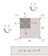
$q_{I} = h \cdot (T_{\infty} - T_{I,I}) \cdot \left(\frac{\Delta y}{2} \cdot I\right)$   $q_{3} = -k \cdot \frac{T_{2,I} - T_{I,I}}{\Delta x} \cdot \left(\frac{\Delta y}{2} \cdot I\right)$
